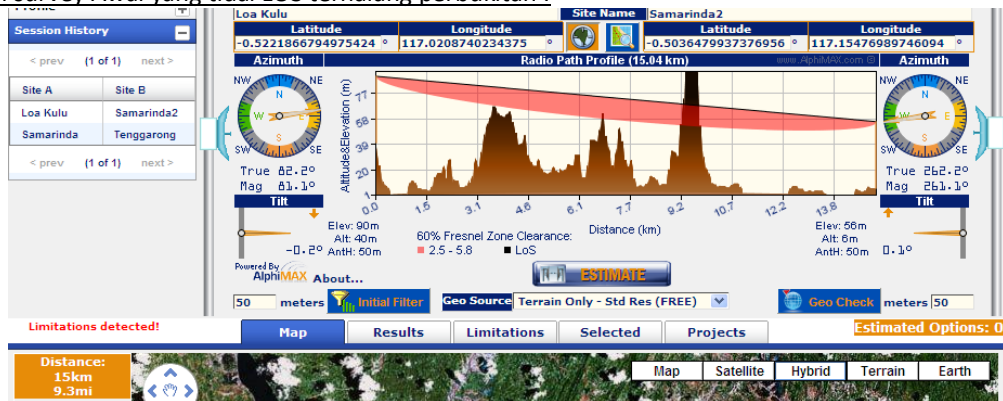
Gambar 2. Kondisi tidak LOS (ada penghalang bukit)
